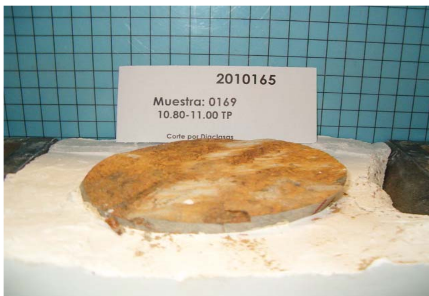
Detalle de la diaclasa después de ser sometida a ensayo
